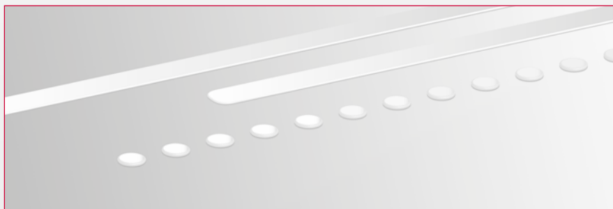
Modo de aplicación de cola en puntos y cordones
