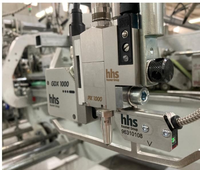
La combinaison idéale : tête d'application de colle froide PX 1000 et capteur de colle froide GDx 1000
