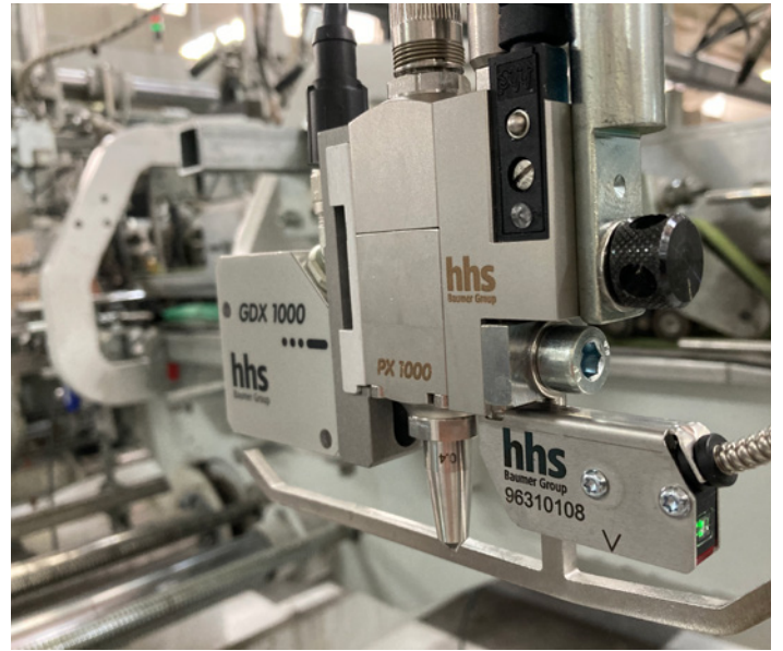
理想的组合：PX 1000冷胶喷枪搭配GDX 1000冷胶传感器
