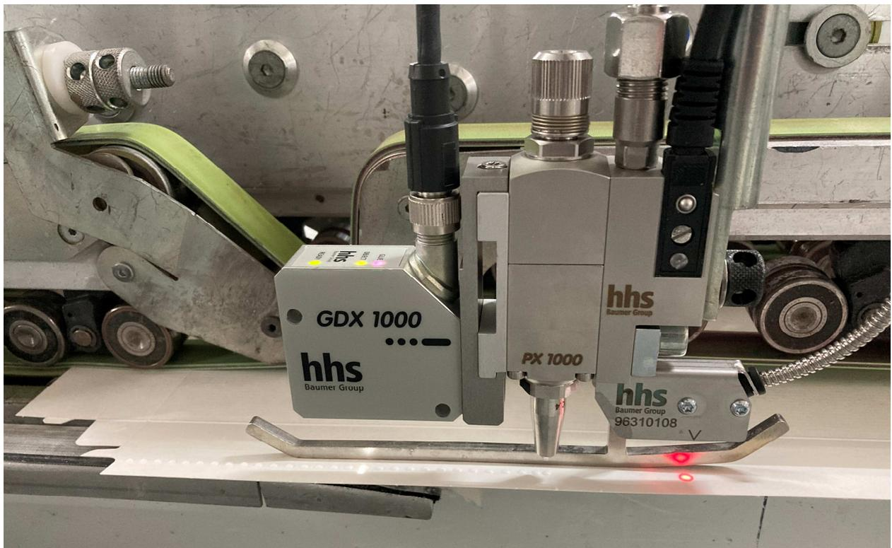
Der Praxistest des neuen Kaltleimventils PX 1000 und des neuen Kaltleim-Überwachungssensors GDx 1000 von Baumer hhs im WestRock-Werk in Düren hat bewiesen: Die neue Technik erhöht noch einmal deutlich die Zuverlässigkeit im Klebstoffauftrag und damit die Produktionssicherheit.
