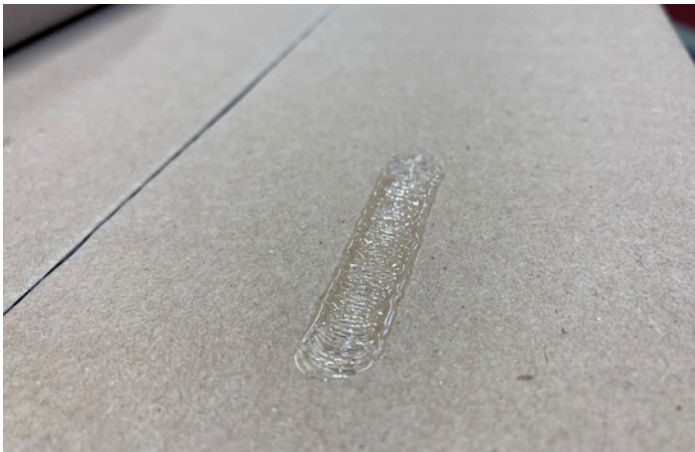
Spiralauftrag zur Palettensicherung
