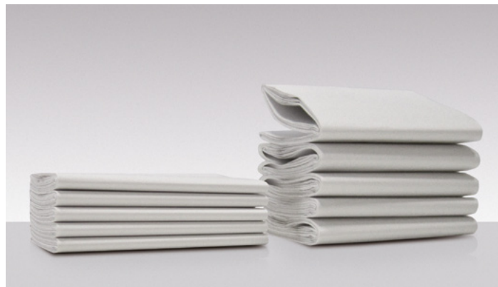
Packungsbeilagen mit Waterscoring überzeugen durch perfekte Planlage.
