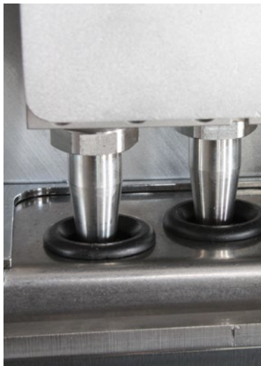
Le bain d'eau à toute épreuve nettoie le pistolet d'application de la tête d'application lors de l'application par le haut.
