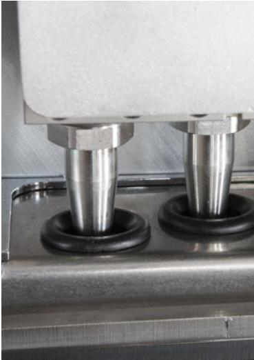
Las válvulas del cabezal se limpian desde arriba al baño maría durante la aplicación.
