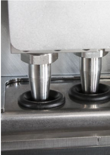
Das bewährte Wasserbad reinigt die Ventile des Auftragskopfes beim Auftrag von oben.
